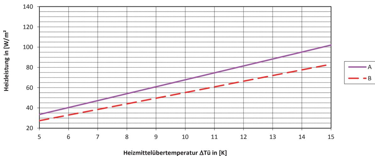
A - OPTIMAT im Betonestrich  $d = 45$  mm und Fliesen  $d = 15$  mm ( $l = 1,05$  W/mK)
